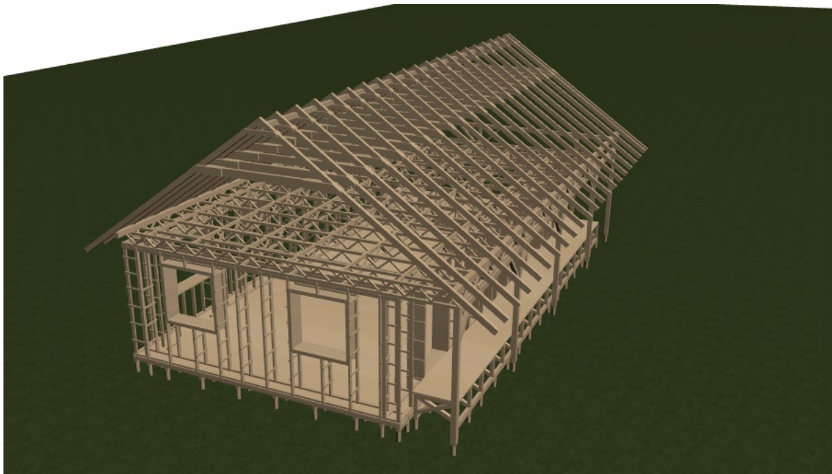
168. ábra Tervezett családi ház: torokgerendás fedélszerkezet
