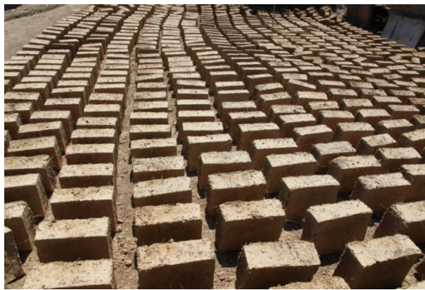
57. ábra Kézi gyártású vályogtégla
