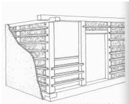
64. ábra Lécek közé rakott fal
