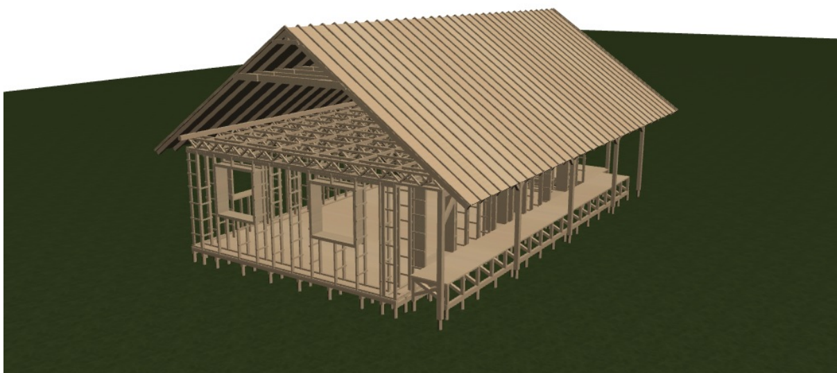
169. ábra Tervezett családi ház: tető héjszerkezet kialakítás közben
