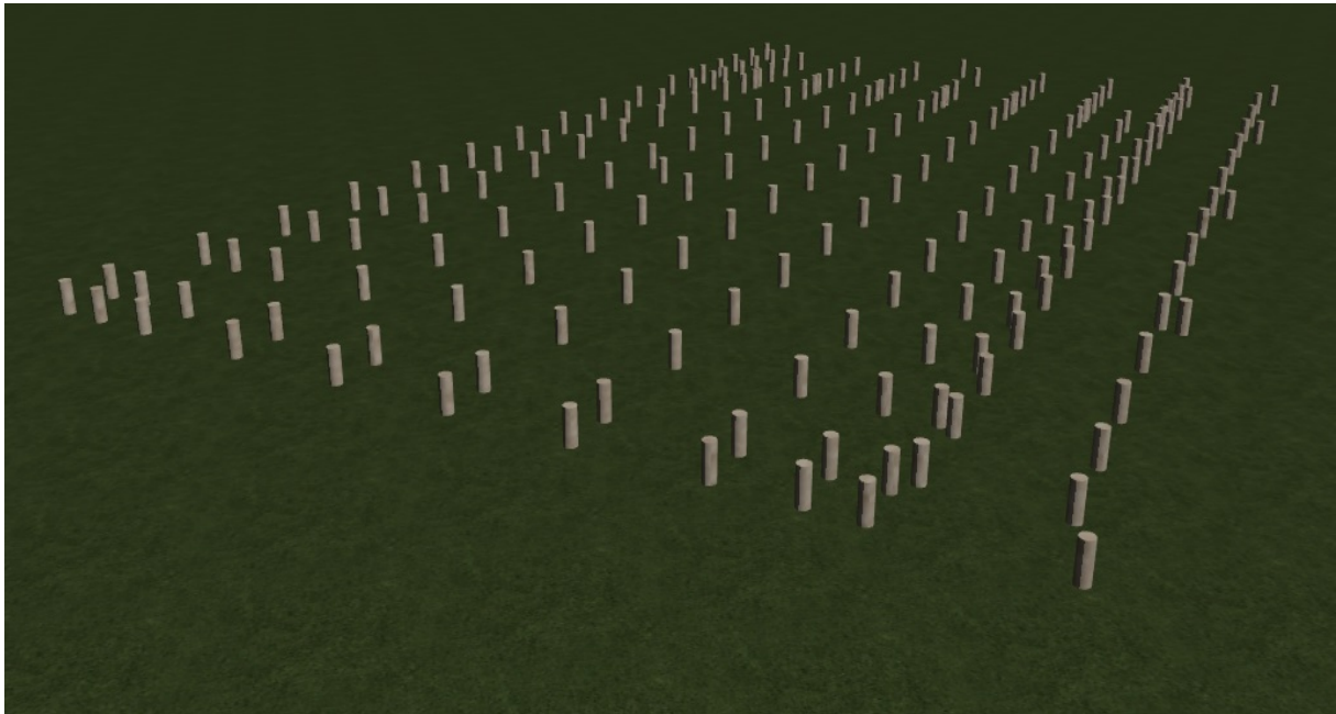
162. ábra Tervezett családi ház: talajcsavaros alapozás
