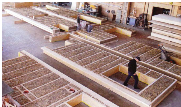
22. ábra Szalma falpanel kialakítása
