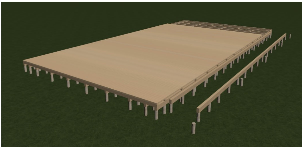
164. ábra Tervezett családi ház: gerendarács pallóborítása
