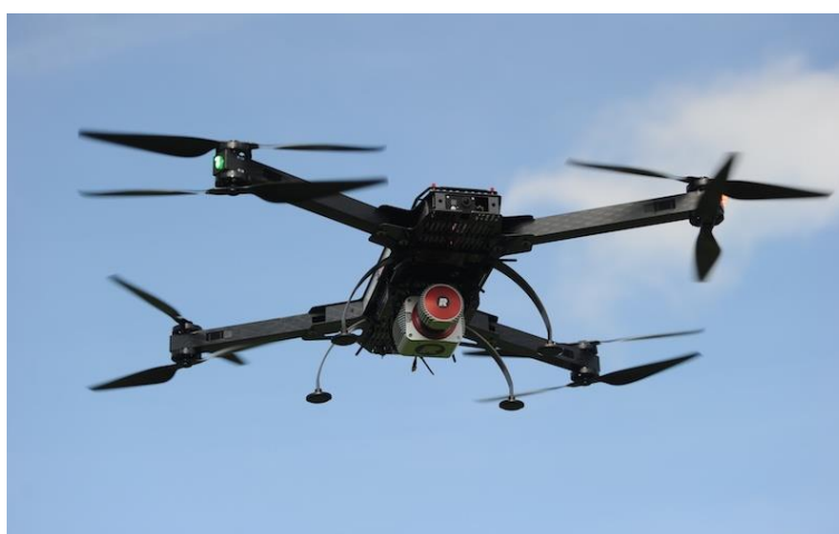
85. ábra Drónra szerelt lézerszkennér pontfelhő készítéshez
