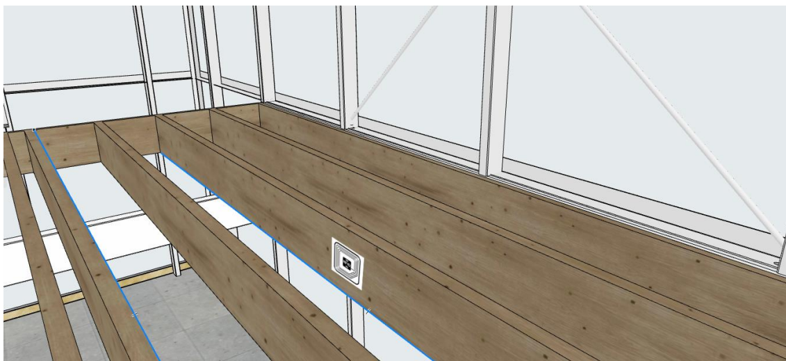
109. ábra RFID címke fa födémgerendán (Saját kép)
