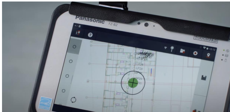
119. ábra Pontkijelölés BIM modellben, alaprajzon táblagép használatával
