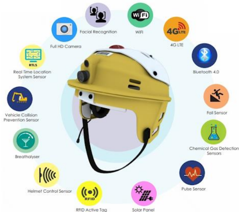
116. ábra IoT technológiával ellátott munkavédelmi sisak
