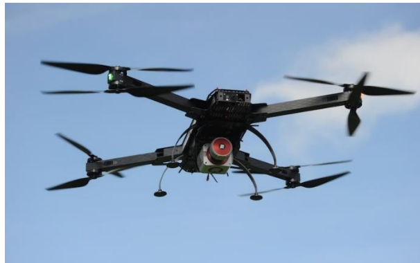
21. ábra RIEGL ULS lézerszkennő drónokhoz
