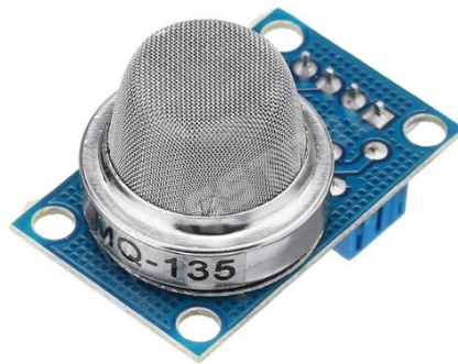
125. ábra MQ-135-M Levegő összetétel érzékelő
