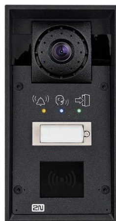
124. ábra Intercom - 2N® IP Force Felhőkapcsolatra képes beléptető rendszer
